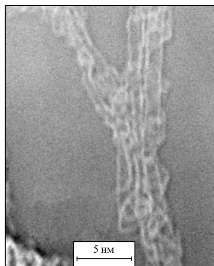
Рис. 10. ПЭМ-Микрофотография высокого разрешения фторированных УНТ, модифицированных действием лауроилпероксида. 151
